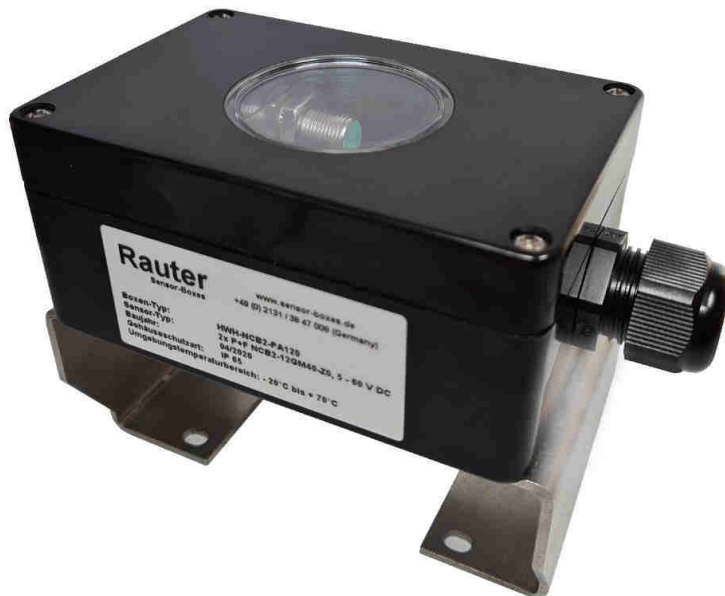
Bild 1: Polyamid (Vestamid)-Endschalterbox, 120x80x55mm für pneumatische Drehantriebe mit Schnittstelle nach VDI/VDE 3845.
