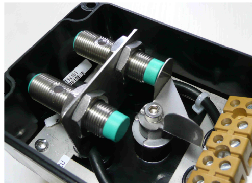
Bild 3: 10 - 60 V DC Pepperl+Fuchs-Sensoren NJ2-12GM40-E2 mit fester Edelstahl-Schaltfahne für 0° und 90°, welche mit einer Innensechskantschraube SW 4mm fest gezogen wird.
