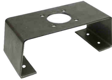
Abb.: Konsolle Gr. 3 und 4 für Antriebe nach VDI/VDE 3845 mit 30 und 50mm Wellenüberstand sowie Bohrbild 130x30mm
